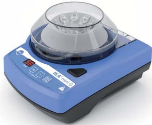
IKA® представляет совершенно новую миницентрифугу для применений, где не требуются сверхвысокие частоты вращения, например, для микрофльтраций и выделения клеток. Отличительная черта миницентрифуги mini G это её компактная конструкция и небольшая занимаемая площадь на рабочем столе. Прозрачная крышка осуществляет возможность постоянного наблюдения за процессом. Миницентрифуга mini G позволяет использовать как микроцентрифужные пробирки, так и стрипованные пробирки для ПЦР.
