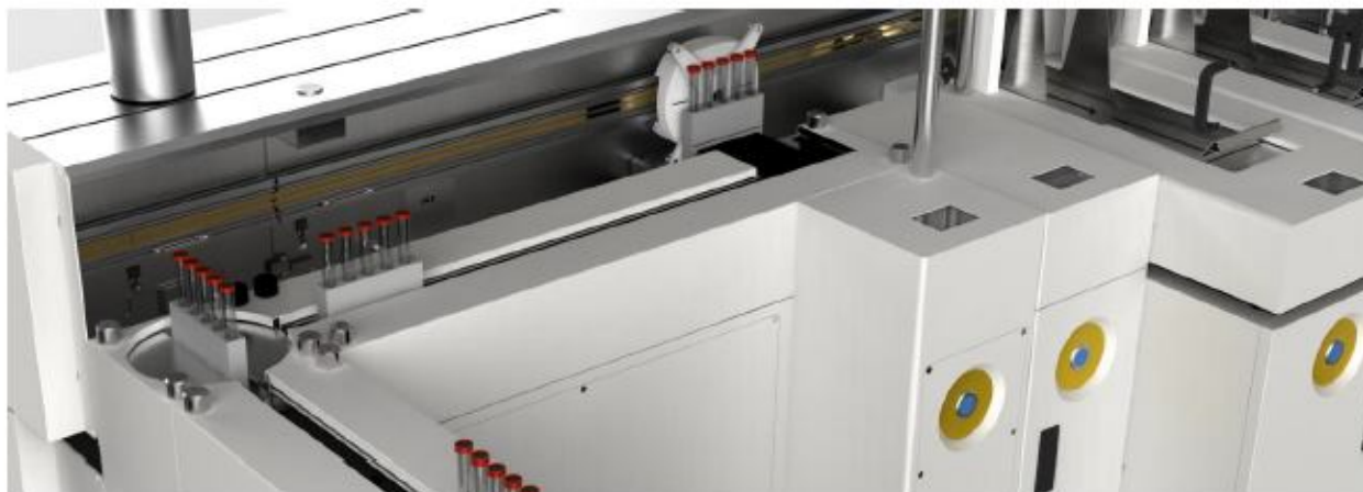
Фотография транспортной системы «FLEXTRAC», находящейся внутри оборудования для флеботомии
